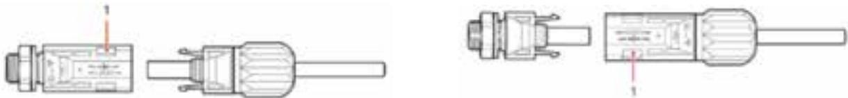
Figura 4-7 Conectando cabos de alimentação de entrada DC
